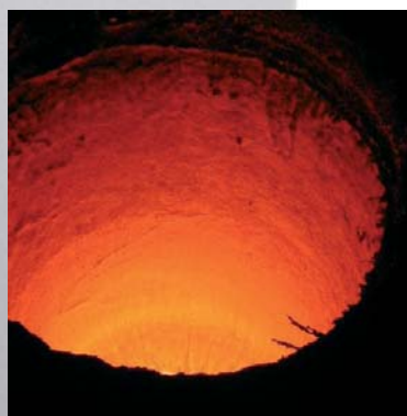
Forno da 25 ton dopo 4 settimane di lavoro. Sono state fuse 2000 ton. NOTARE il RIVESTIMENTO PULITO.
