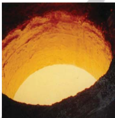
Il forno è pronto per la seconda spillata. NOTARE il METALLO PULITO e la SUPERFICIE DEL RIVESTIMENTO.
