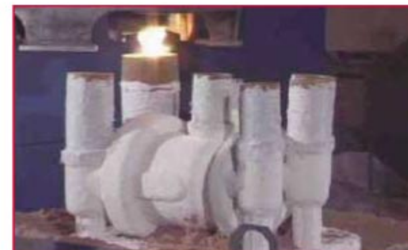
Figura 20: Speciale forma a guscio utilizzata per facilitare la visualizzazione radiologica del getto della valvola durante la colata.
