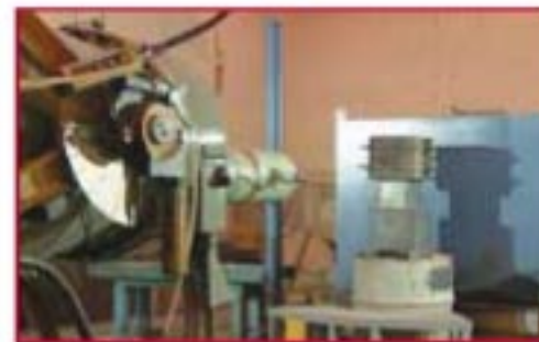
Figura 8: Configurazione dell'esame radiologico in tempo reale.
