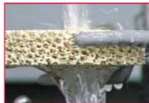
Figura 1: Il filtro spugnoso ceramico riduce la turbolenza del flusso d'acqua
