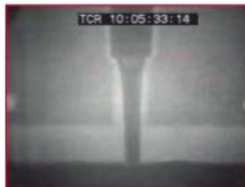
Figura 14: Immagine radiologica del getto su placca colato dall'alto con filtro, nella quale si nota la ridotta turbolenza del metallo all'ingresso del getto.
