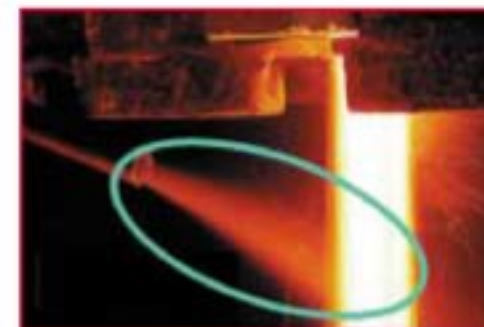
Figura 12: Inoculazione sul flusso di colata impiegata in condizioni ottimali.
