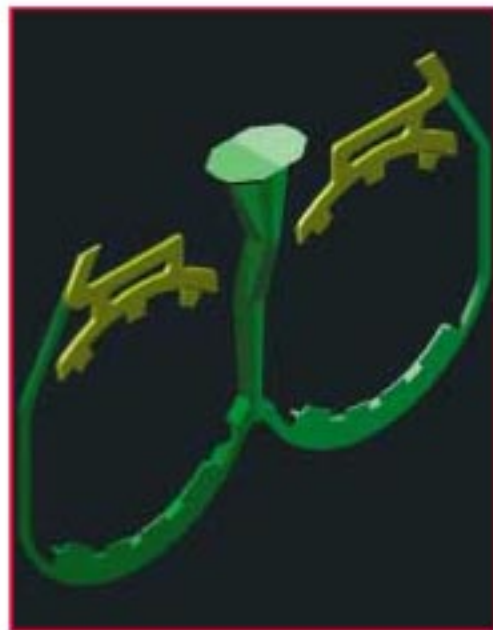
Figura 5: Sistema di colata attuale. L'attacco di colata e il flusso si trovano sullo stesso piano.
