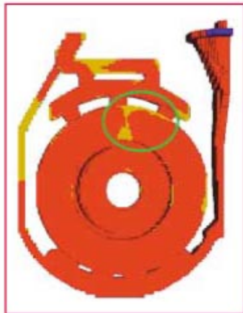
Figura 4: Area di metallo freddo indicante la presenza di grafite sottoraffreddata.
