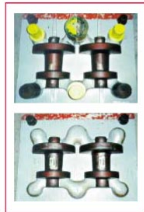
Figura 8: Modelli delle staffe superiore e inferiore per il getto del corpo valvola a 2 uscite
