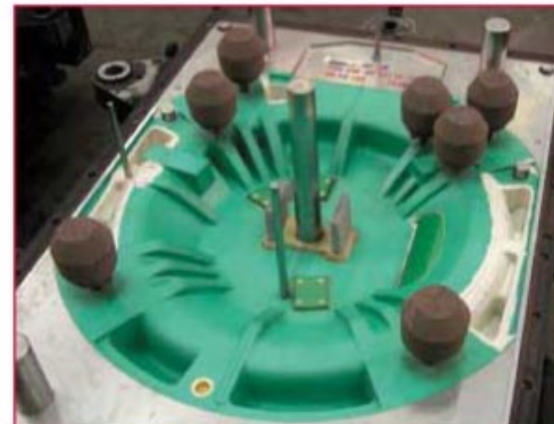
Figura 7: Esempio di getto 2 con l'impiego di sette manicotti.
