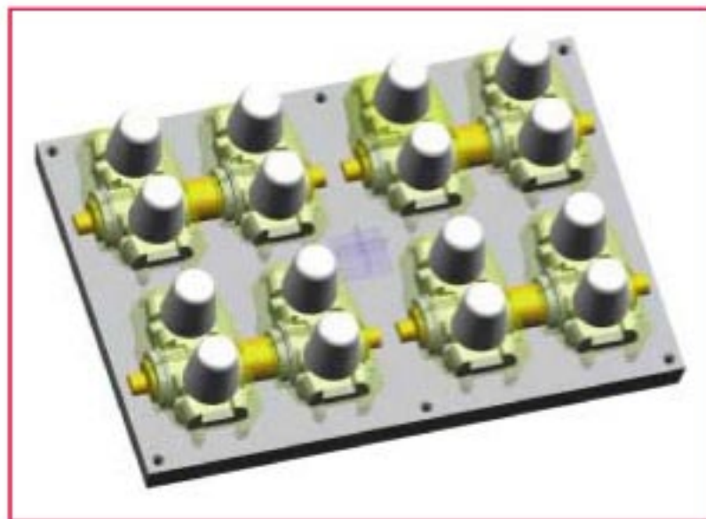
Figura 5: Esempio di getto 1 con l'impiego di alimentatori di sabbia tradizionali.
