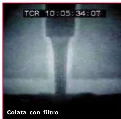
Figura 12: L'analisi radiologica mostra la capacità della filtrazione di ridurre la turbolenza del metallo fuso che penetra nella cavità del getto.
