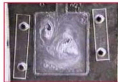
Figura 1a: Placca-modello ad acqua colata dall'alto, flusso non filtrato.
